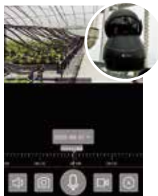
スマホによるリモートカメラ操作とハウス内の確認
